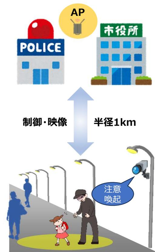
11ahの通信帯域が、異常発生時の映像と街路灯制御を双方向で実現し安心安全な街を作る
